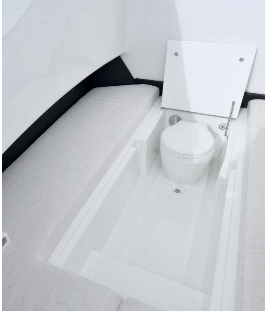
Доступ в отсек под постом управления осуществляется с носа
