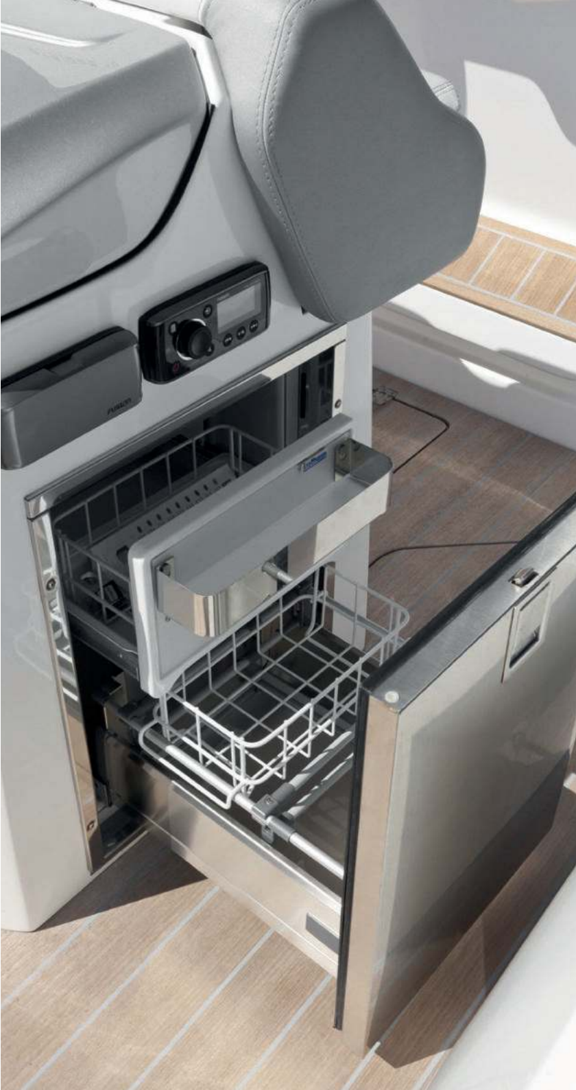
Выдвижной холодильник Inox под сдвоенным креслом рулевого
